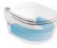
El primer inodoro que no necesita la instalación de una cisterna porque el depósito de agua está integrado en la propia taza. Un sistema de inyección de aire empuja el agua del depósito hacia la parte superior de la taza, proporcionando una descarga altamente efectiva.
