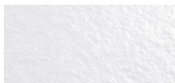
**Sanylite** es un material compuesto por un núcleo de GRP y una superficie de gel coat. Los productos fabricados con **sanylite** tienen un peso cuatro veces menor que el de productos equivalentes en **sanydur** u otros composites.
